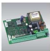
■ Quadro de controlo 624 BLD
