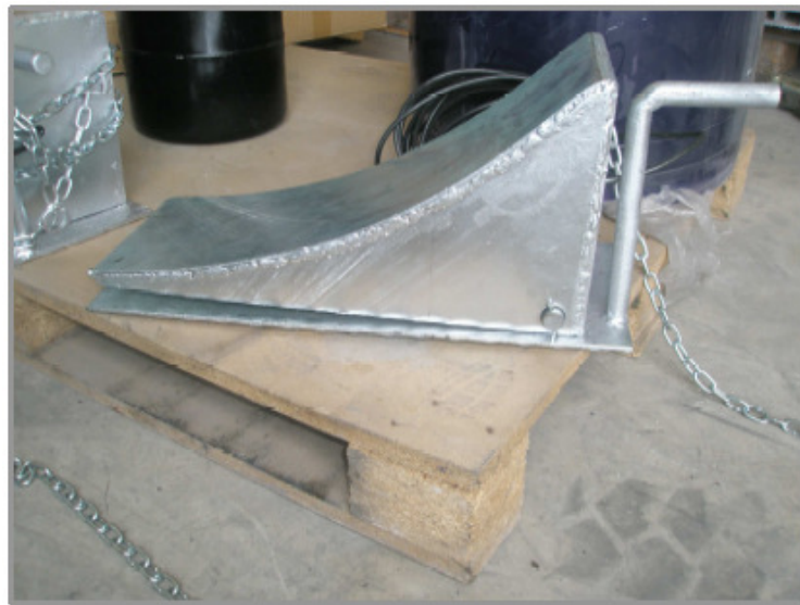
BLOQUEIO DE RODAS MANUAL COM MICROSWITCH E CABO PARA LIGACÃO A SEMÁFORO
