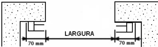
(A) Interior do Vão
